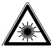
Il telecomando possiede un puntatore laser che emette un raggio laser di Classe II dalla finestrella di luce laser. Non fissare lo sguardo direttamente sul raggio, né dirigere il raggio verso altre persone. Le due indicazioni a sinistra sono richiami di attenzione relativi al raggio laser. Usare sempre il puntatore laser a temperature comprese tra +5°C e +40°C.
