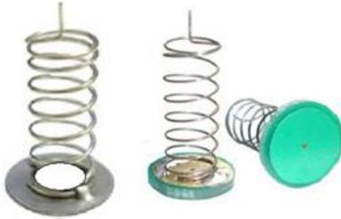
图 3: 金属弹簧做电容传感器（按键感应盘）
