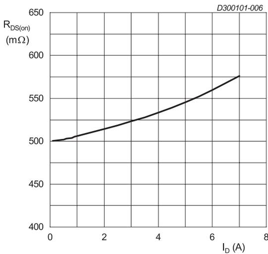
$V_{GS} = 10\text{ V}$
