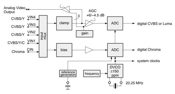
Fig. 2-1: Analog front-end
