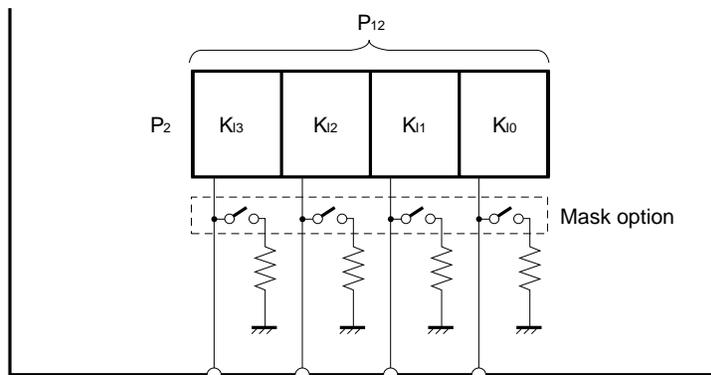
11.4 K<sub>i</sub> PULL-DOWN RESISTOR CONFIGURATION
