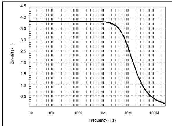
**COMMON INPUT IMPEDANCE VERSUS FREQUENCY**
