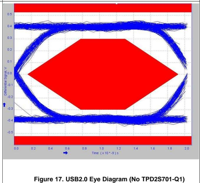
Figure 17. USB2.0 Eye Diagram (No TPD2S701-Q1)
