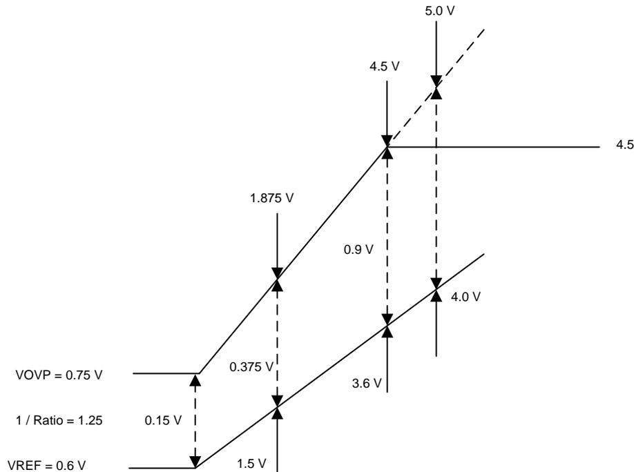
**Figure 20. OVP Threshold**
