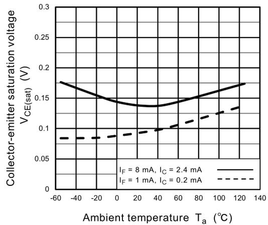
**Fig. 11.10  $V_{CE(sat)} - T_a$**
