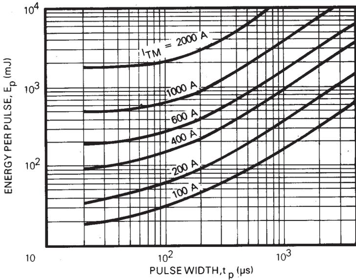
FIG. 6 ENERGY PER PULSE FOR SINUSOIDAL PULSES
