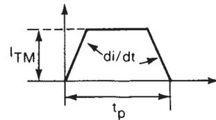
**FIG. 9 ENERGY PER PULSE FOR TRAPEZOIDAL PULSES**
