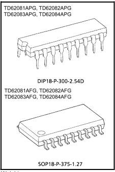
Weight DIP18-P-300-2.54D: 1.47 g (typ.) SOP18-P-375-1.27: 0.41 g (typ.)
