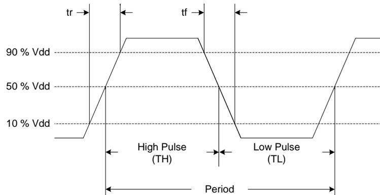
Figure 15. LVCMOS Waveform Diagram<sup>[14]</sup>
