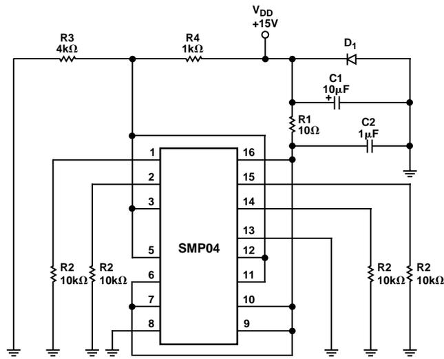
Figure 28. Burn-In Circuit
