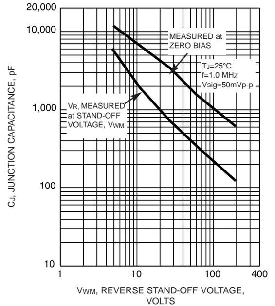
FIG. 5 - TYPICAL JUNCTION CAPACITANCE BIDIRECTIONAL
