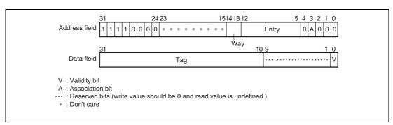
Figure 7.5 Memory-Mapped IC Address Array
