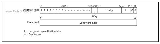
Figure 7.6 Memory-Mapped IC Data Array
