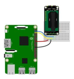
Pi 3V to sensor VIN (red wire)
