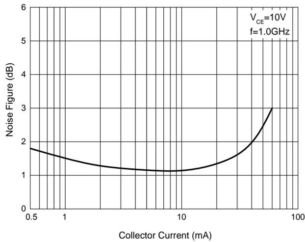
Fig. 4 -  $N_F$ - $V_{CE}$
