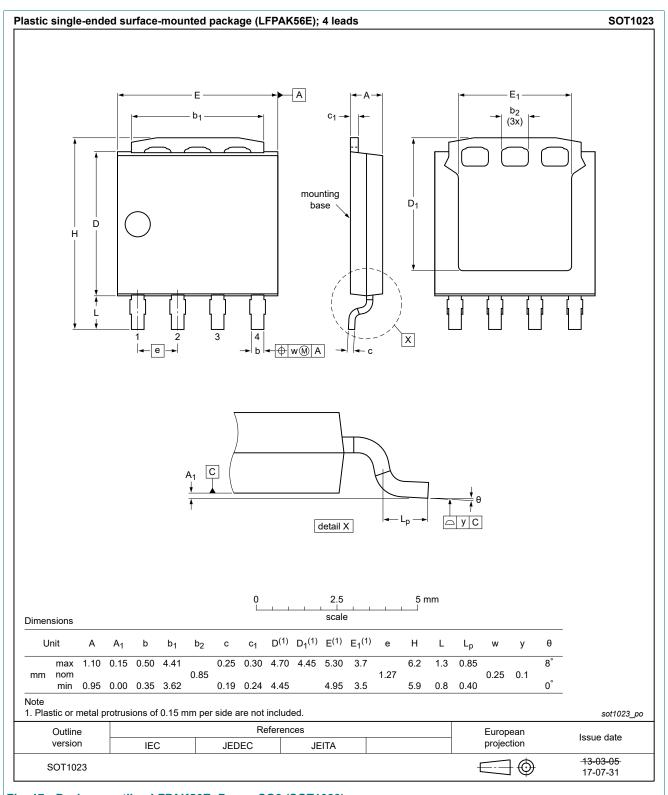
Fig. 17. Package outline LFPAK56E; Power-SO8 (SOT1023)
