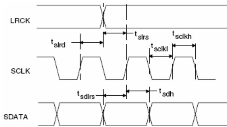
图 4 外部串行模式输入时序
