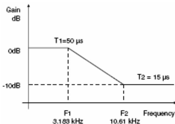
图 9 去加重曲线 ( $F_s=44.1\text{kHz}$ )
