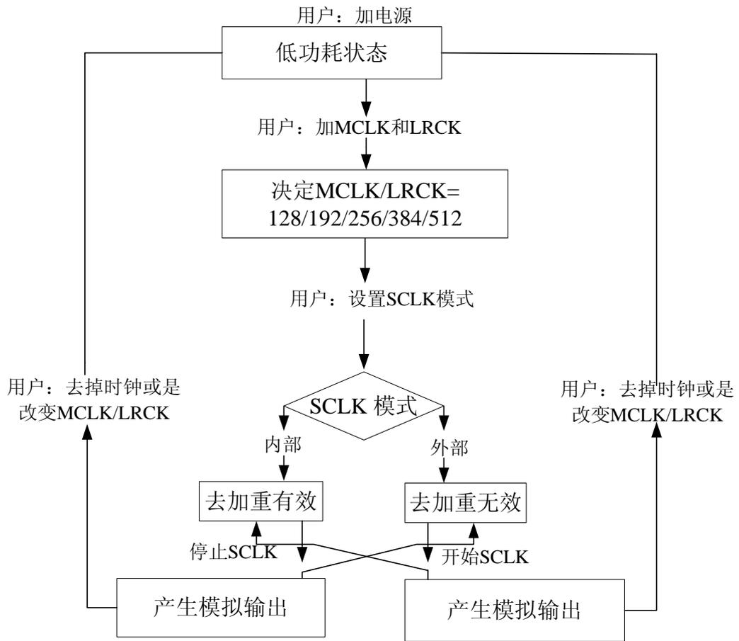
图 14 MXT8234 初始化和低功耗的顺序框图
