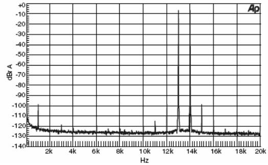
(16K FFT 互调失真 13KHz 和 14kHz 输入信号)
