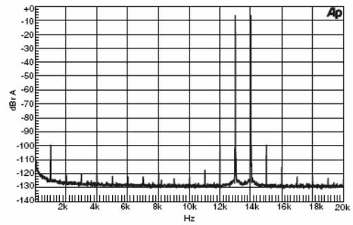
(16K FFT 互调失真 13KHz 和 14kHz 输入信号)
