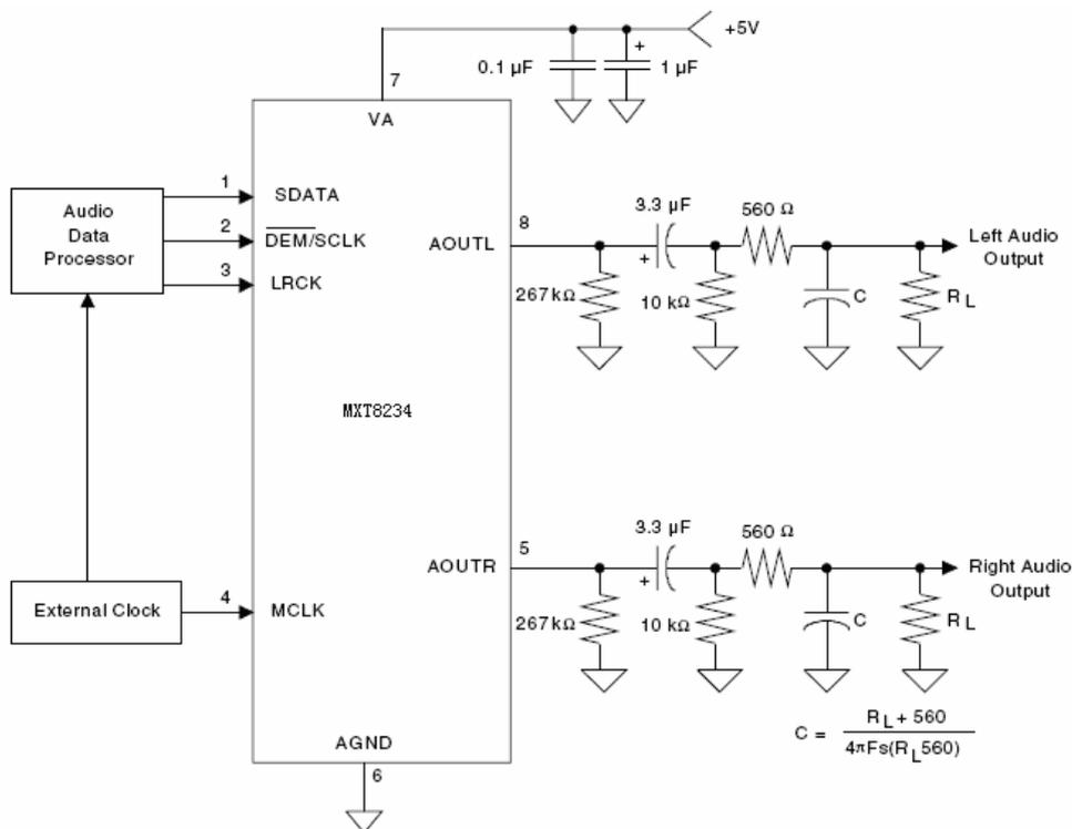
图 7 推荐连接图
