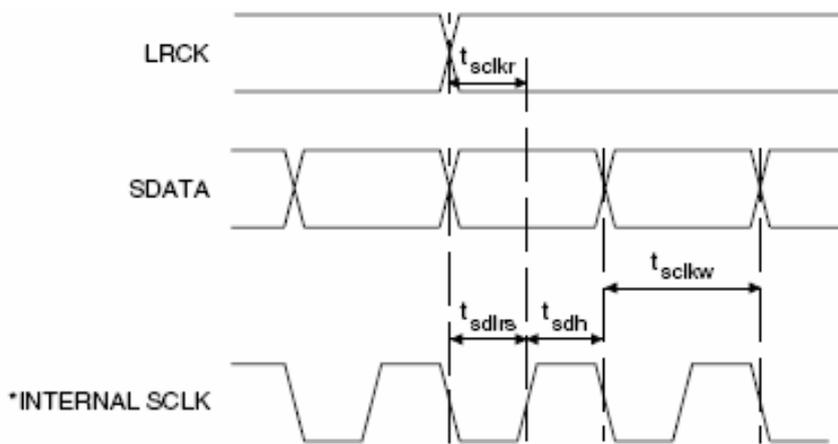
图 5 内部串行模式输入时序
