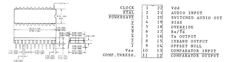
MX325 ENCODER/DECODER: (Refer to Test Circuit, Fig. 1)
