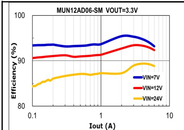
**FIG.27 EFFICIENCY V.S. LOAD CURRENT**
