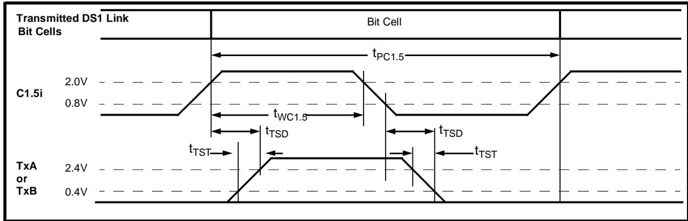
Figure 19 - Transmit Timing for DS1 Link
