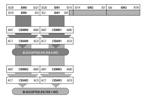
Figure 20-4. Dual 16-Bit Maskable Acceptance Filters
