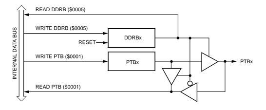
Figure 19-6. Port B I/O Circuit
