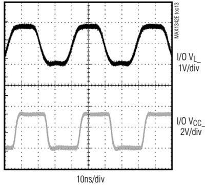
**TYPICAL I/O  $V_{CC\_}$  DRIVING**
