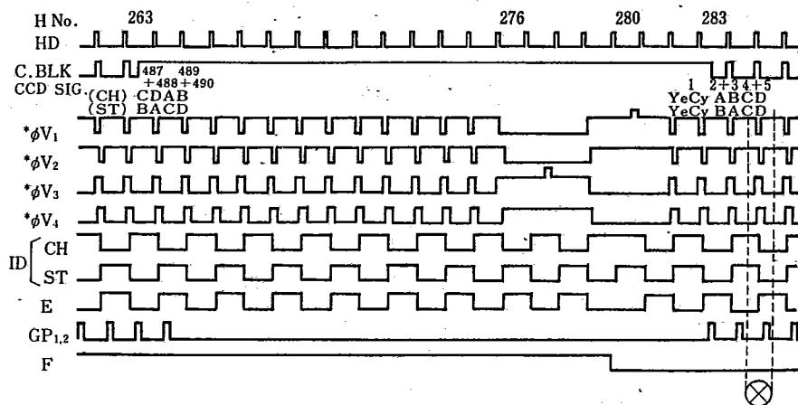
\* φ V<sub>1</sub>-φ V<sub>4</sub> pulses apply to the CCD.
