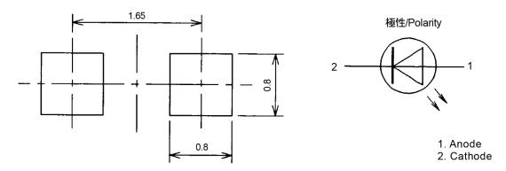
(注 1) パッケージ寸法については電極バリを含まない。(Note1) Electrode projection is not included in the package dimensions.
