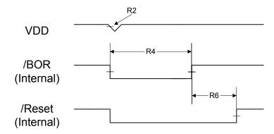
Figure 24-7. Software Reset Timing
