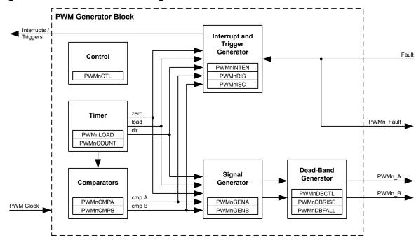
Figure 15-2. PWM Module Block Diagram
