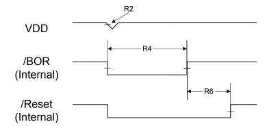
Figure 20-7. Software Reset Timing
