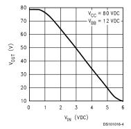
FIGURE 3. V<sub>IN</sub> vs V<sub>OUT</sub>
