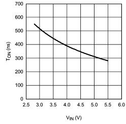
$T_{\rm ON}$  vs  $V_{\rm IN}$  (LM1770S)
