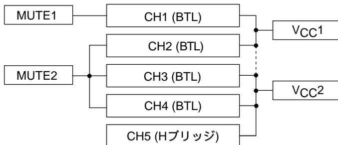
V<sub>CC1</sub>、V<sub>CC2</sub>は内部にて接続されているが、外部にて接続すること。
