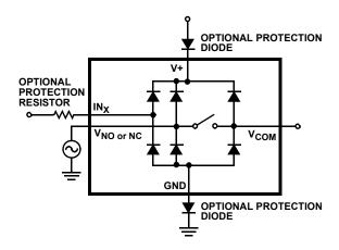
FIGURE 8. OVERVOLTAGE PROTECTION
