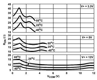
FIGURE 10. ON RESISTANCE vs SWITCH VOLTAGE
