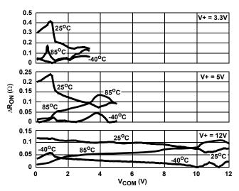
FIGURE 11. R<sub>ON</sub> MATCH vs SWITCH VOLTAGE
