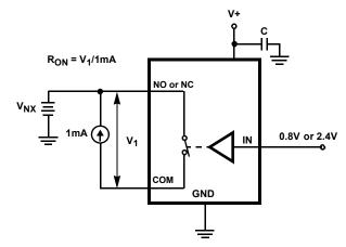
FIGURE 5. R<sub>ON</sub> TEST CIRCUIT
