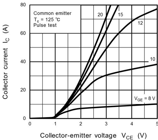
**Fig. 8.3**  $I_C - V_{CE}$
