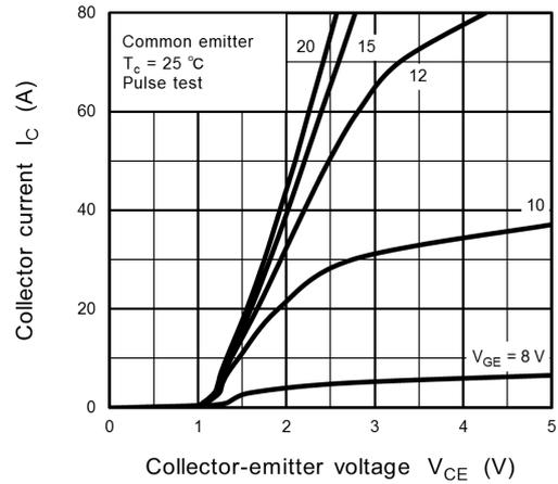
**Fig. 8.2**  $I_C - V_{CE}$
