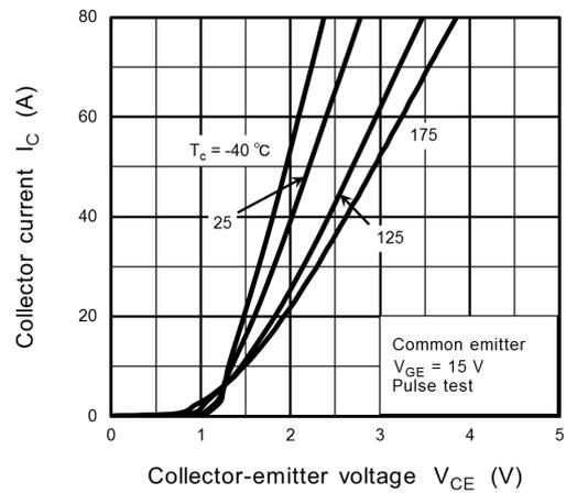
**Fig. 8.4**  $I_C - V_{CE}$
