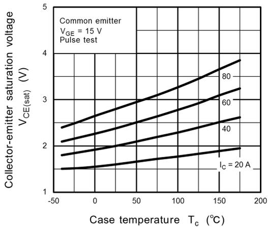
**Fig. 8.5**  $V_{CE(sat)} - T_c$
