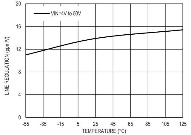
图 15. 输入调整率和温度的关系, V<sub>OUT</sub>=2.048V
