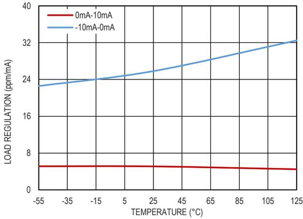
图 12. 负载调整率和温度的关系, V<sub>OUT</sub>=3.3V
