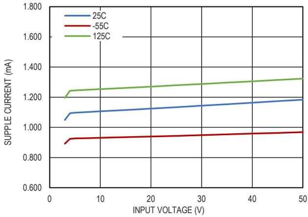
图 18. 输入电流和输入电压的关系,  $V_{OUT}=1.25V$
