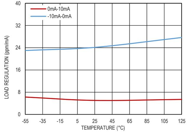
图 13. 负载调整率和温度的关系, V<sub>OUT</sub>=4.096V
