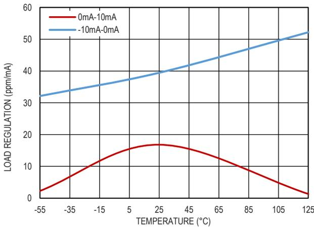
图 10. 负载调整率和温度的关系,  $V_{OUT}=1.25V$
