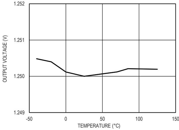
图 6. 1.25V 输出电压和温度的关系
