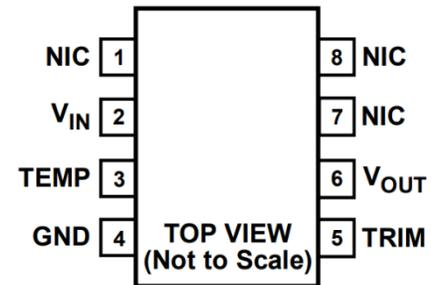
图 2. 8 引脚 SOIC
