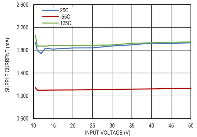
图 21. 输入电流和输入电压的关系,  $V_{OUT}=4.096V$
