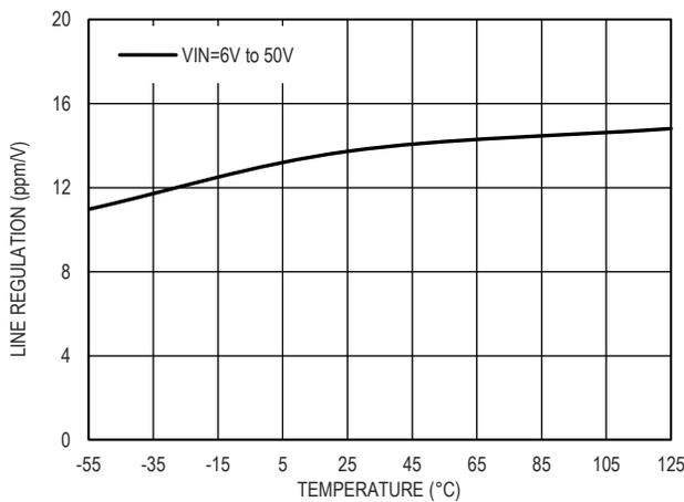
图 16. 输入调整率和温度的关系, V<sub>OUT</sub>=3.3V
