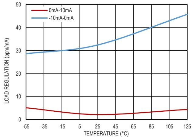
图 11. 负载调整率和温度的关系,  $V_{OUT}=2.048V$
