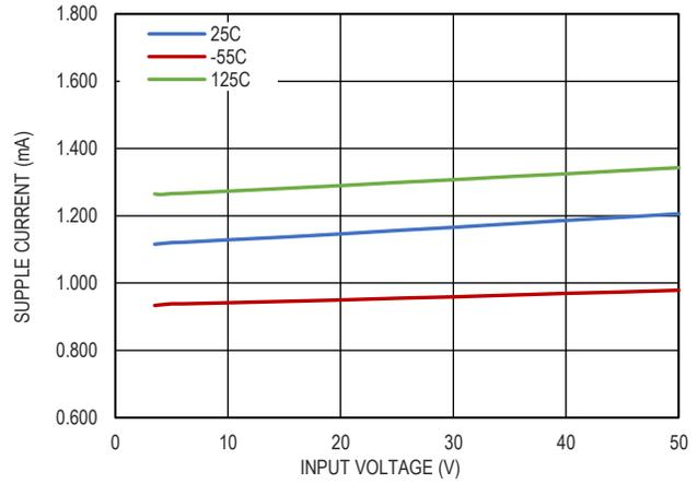
图 19. 输入电流和输入电压的关系,  $V_{OUT}=2.048V$
