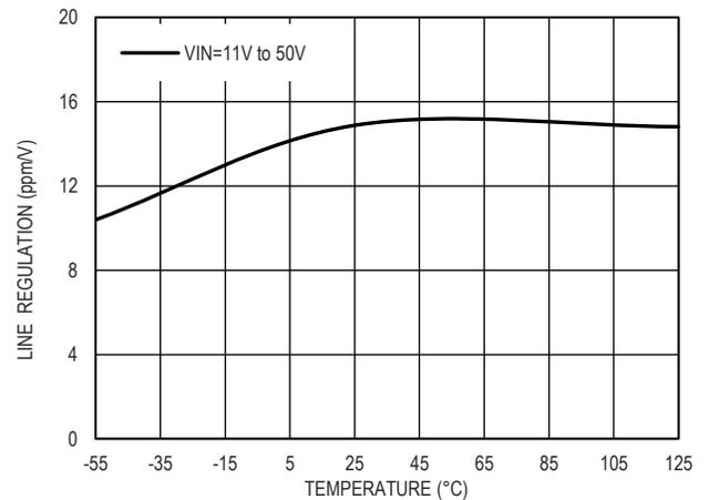
图 17. 输入调整率和温度的关系, V<sub>OUT</sub>=4.096V
