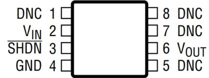
图 1. 8 引脚 MSOP
