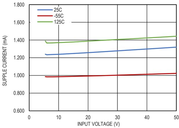
图 20. 输入电流和输入电压的关系,  $V_{OUT}=3.3V$
