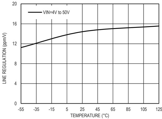
图 14. 输入调整率和温度的关系, V<sub>OUT</sub>=1.25V
