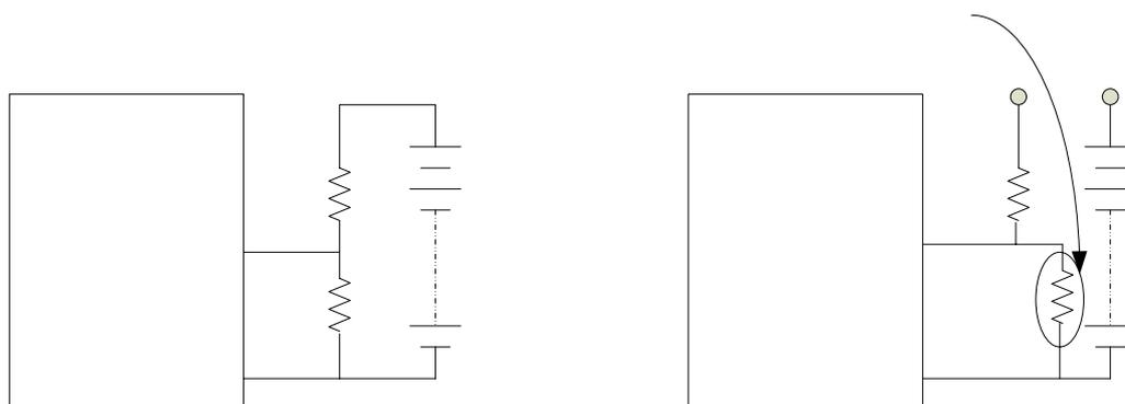
图 2 电池电压和温度检测原理图
