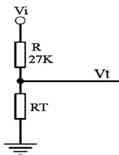
图 4 热敏电阻应用电路图
