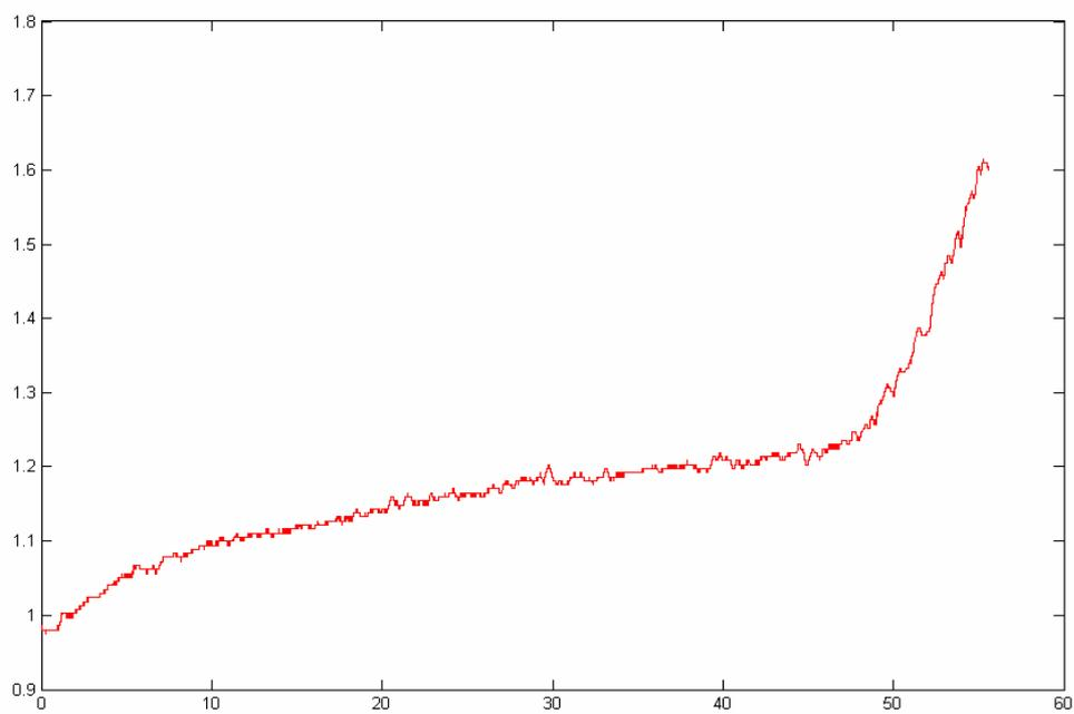
图 9.2 采用 G M6802C 对 2 节串联 800mAh 镍氢电池组进行充电的温度曲线
