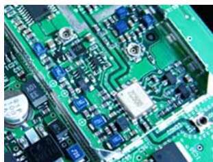
NL系列的使用例 > ETC车载器 接收电路的IF信号线
