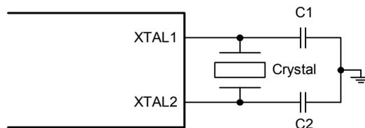
(3)晶体/陶瓷谐振器: 400kHz – 16.6MHz
