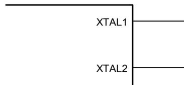
(2)晶体谐振器: 32.768kHz和内部RC振荡器: 16.6MHz
