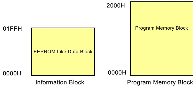
G80F903为存储程序代码内置8K可编程Flash程序存储区（Program Memory Block），支持在线编程（ICP）模式和扇区自编程（SSP）模式对Flash存储器操作。每个扇区1024字节。
