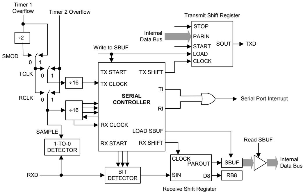
任何将SBUF作为目标寄存器的写操作都会启动发送，实际上发送是从16分频计数器中的下一次跳变之后的系统时钟开始的，因此位时间与16分频计数器是同步的，与对SBUF的写操作不同步。起始位首先在TxD引脚上移出，然后是8位数据位。在发送移位寄存器中的所有8位数据都发送完后，停止位在TxD引脚上移出，在停止位发出的同时TI标志置1。
