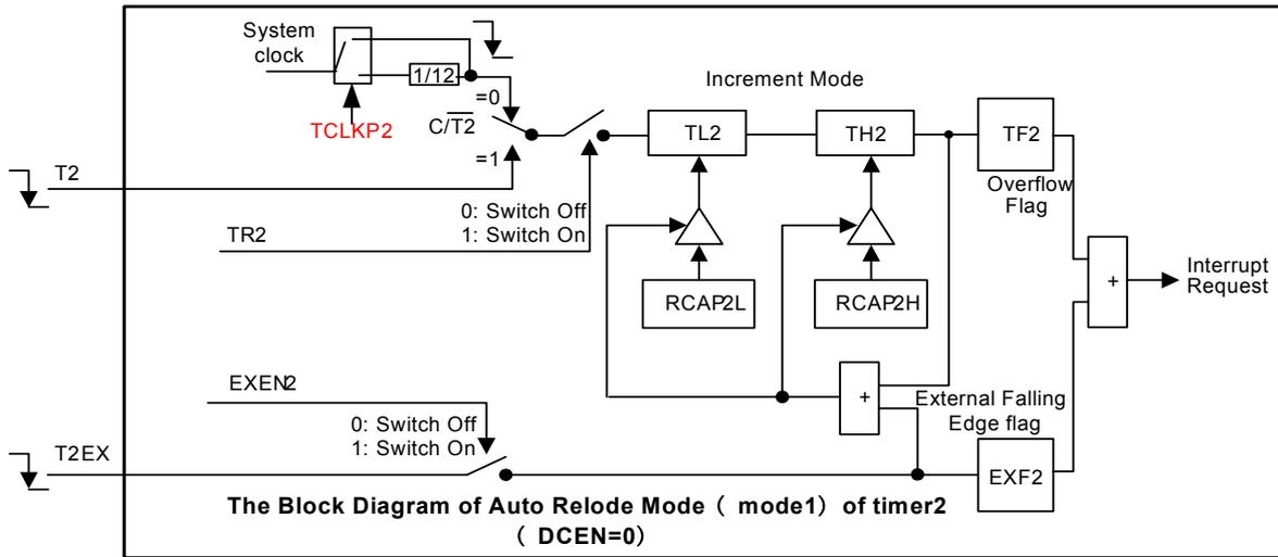
设置DCEN位允许定时器2递增计数或递减计数。当DCEN = 1时, T2EX引脚控制计数的方向, 而EXEN2控制无效。
