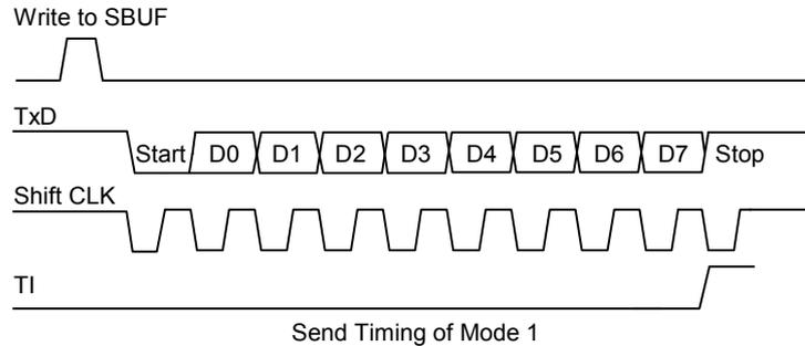
只有REN位置1时才允许接收。当RxD引脚检测到下降沿时串行口开始接收串行数据。为此，CPU对RxD不断采样，采样速率为波特率的16倍。当检测下降沿时，16分频计数器立即复位，这有助于16分频计数器与RxD引脚上的串行数据位同步。16分频计数器把每一位的时间分为16个状态，在第7、8、9状态时，位检测器对RxD端的电平进行采样。为抑制噪声，在这3个状态采样中至少有2次采样值一致数据才被接收。如果所接收的第一位不是0，说明这位不是一帧数据的起始位，该位被忽略，接收电路被复位，等待RxD引脚上另一个下降沿的到来。若起始位有效，则移入移位寄存器，并接着移入其它位到移位寄存器。8个数据位和1个停止位移入之后，移位寄存器的内容被分别装入SBUF和RB8中，RI置1，但必须满足下列条件：
