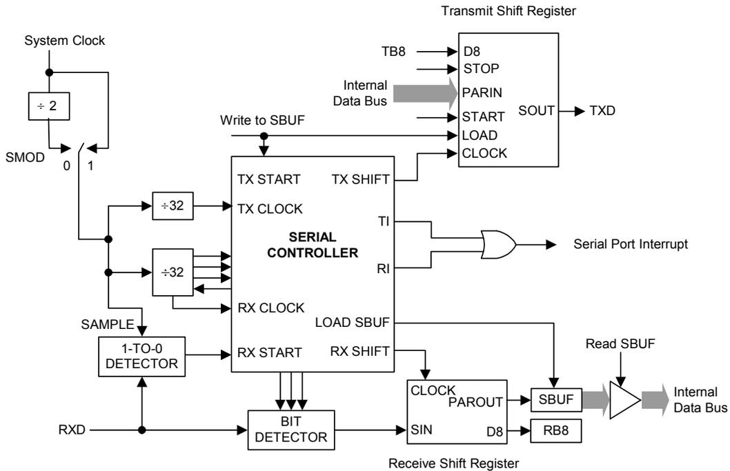
任何将SBUF作为目标寄存器的写操作都会启动发送,同时也将TB8载入到发送移位寄存器的第9位中。实际上发送是从16分频计数器中的下一次跳变之后的系统时钟开始的,因此位时间与16分频计数器是同步的,与对SBUF的写操作不同步。起始位首先在TxD引脚上移出,然后是第9数据位。在发送转换寄存器中的所有9位数据都发送完后,停止位在TxD引脚上移出,在停止位开始发送时TI标志置1。
