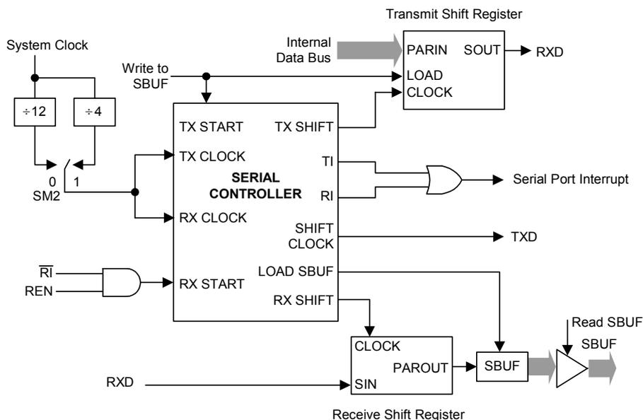
任何将SBUF作为目标寄存器的写操作都会启动发送。下一个系统时钟Tx控制块开始发送。数据转换发生在移位时钟的下降沿，移位寄存器的内容逐次从左往右移位，空位置0。当移位寄存器中的所有8位都发送后，Tx控制模块停止发送操作，然后在下一个系统时钟的上升沿将TI置1 (SCON.1)。
