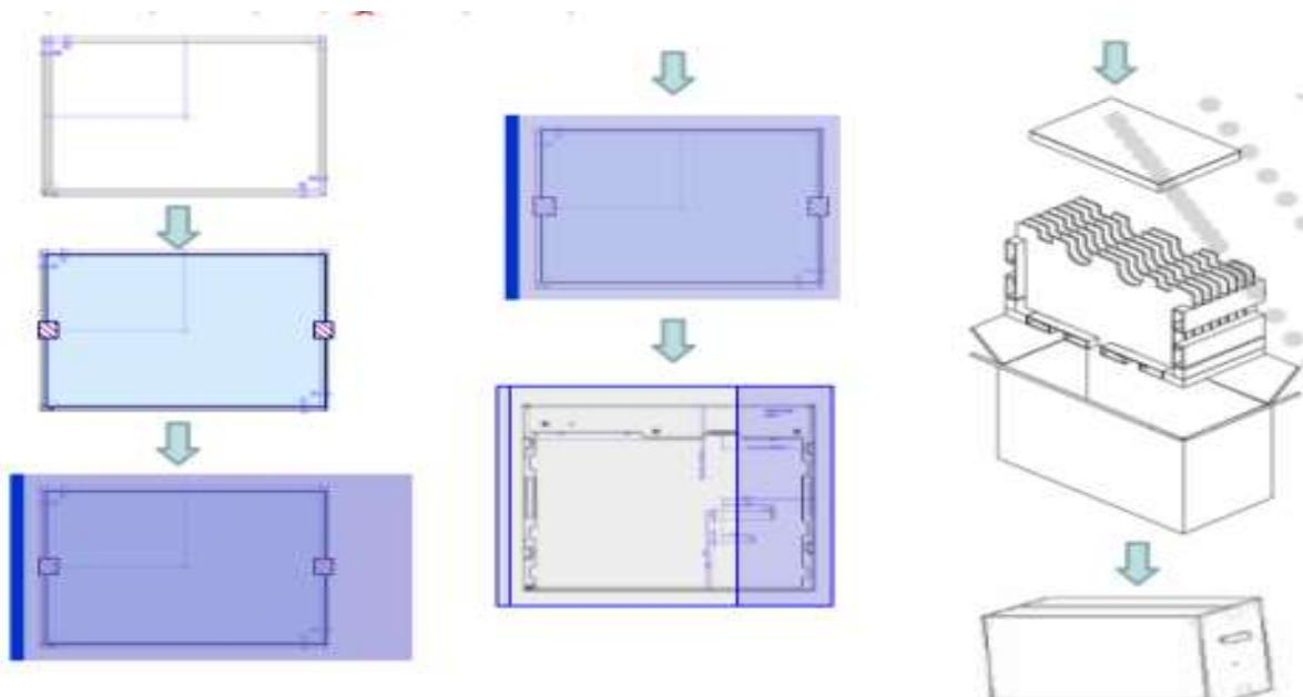
Max capacity : 8 TFT-LCD module per carton
