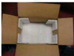
取出紙箱膠帶打 "H" 字型封住箱底，再放入四周緩衝 EPE 材料。
