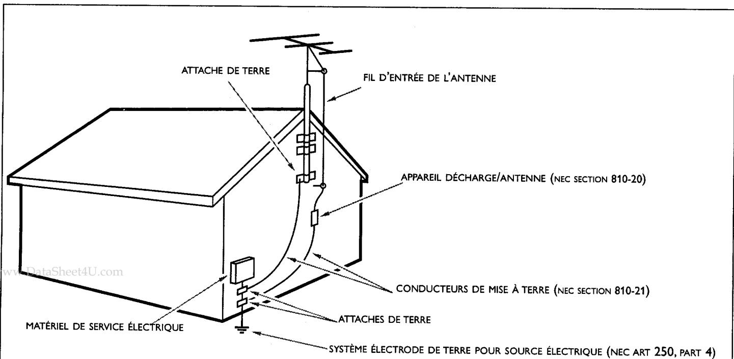
**Remarque pour l'installateur du système câble :** Ce rappel sert à attirer l'attention de l'installateur du système câble à l'Article 820-40 du National Electrical code. Cet article donne les conseils pour la bonne mise à terre et, en particulier, spécifie que la terre du câble doit être reliée au système de mise à terre du bâtiment le plus près possible de l'endroit où le câble y pénètre.
