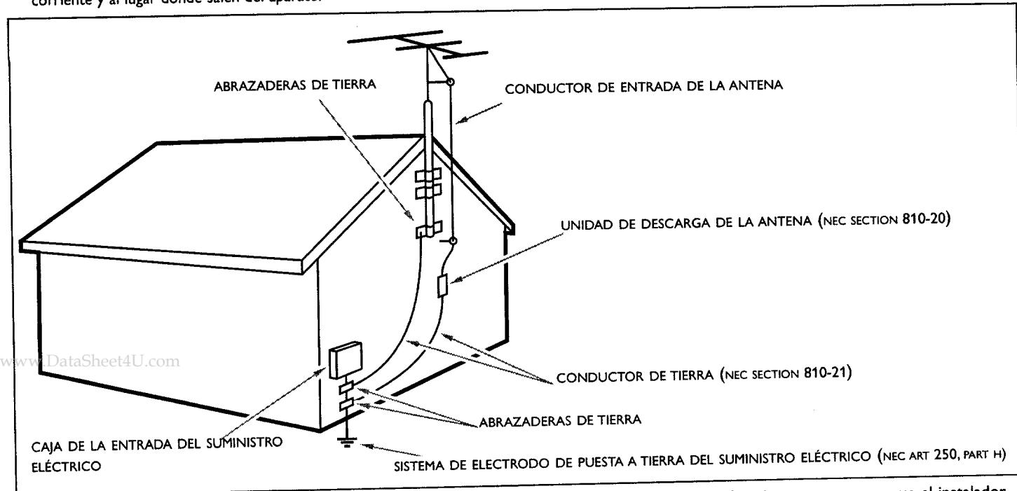
**NOTA PARA EL INSTALADOR DEL SISTEMA DE TELEVISIÓN POR CABLE :** este recordatorio se provee para que el instalador de Televisión por Cable preste atención al Artículo 820-40 de las Normas para Instalaciones Eléctricas (NEC). Este artículo provee los consejos para las puestas a tierra apropiadas y especifica en particular que hay que conectar el cable de puesta a tierra al sistema de puesta a tierra del edificio lo más cerca del punto de entrada del cable como sea conveniente.
