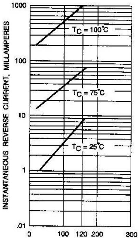
Fig. 3-TYPICAL REVERSE CHARACTERISTICS
