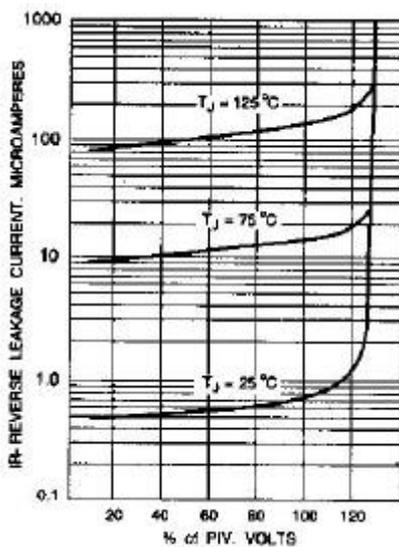
Fig. 5-TYPICAL REVERSE CHARACTERISTICS
