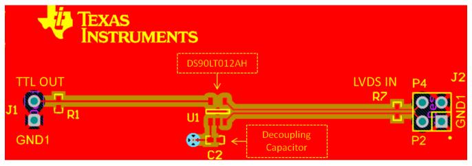
Figure 25. Example DS90LT012AH Layout
