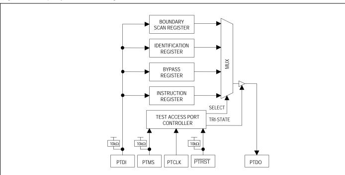
Figure 9-1. Periphery JTAG Block Diagram
