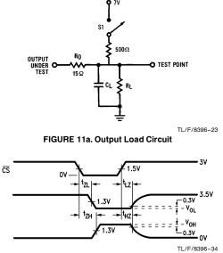
FIGURE 11b. DP8417 TRI-STATE Waveforms
