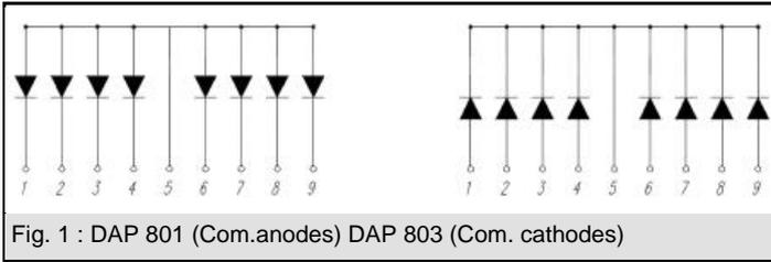
Fig. 1 : DAP 801 (Com. anodes) DAP 803 (Com. cathodes)
