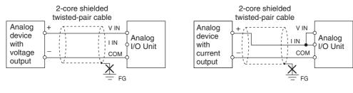
• Wiring Analog Outputs
