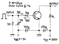
Unit (resistance :  $\Omega$ , capacitance : F)
