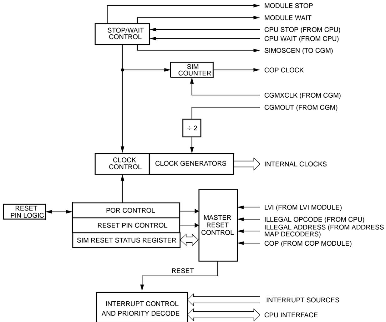
**Figure 7-1. SIM Block Diagram**
