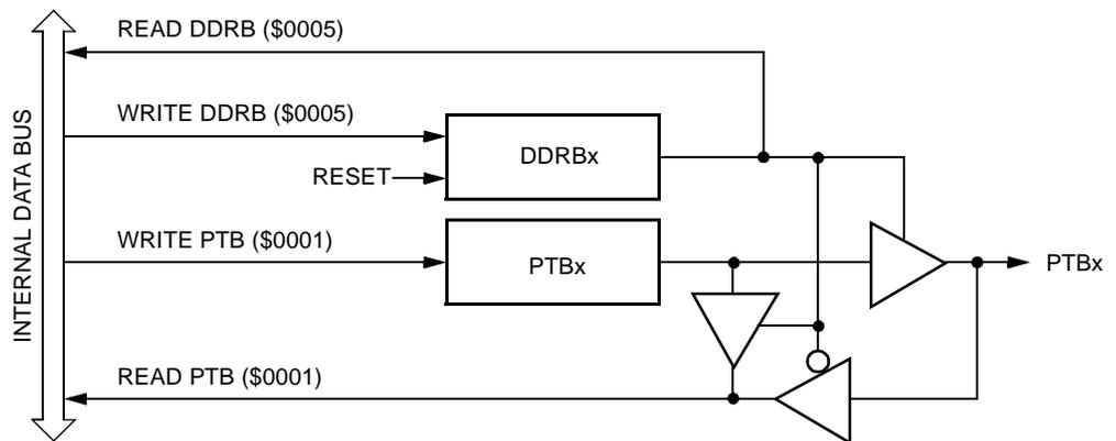
Figure 19-6. Port B I/O Circuit
