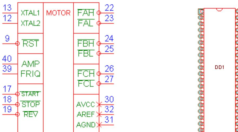
Микросхема выполнена на базе программируемого контроллера AT90S8535. Она поставляется в корпусе DIP40 с загруженной программой управления. Частота синхронизации 8МГц. При этом частота ШИМ составляет 12 кГц.
