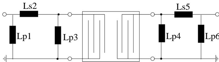
$L_{p1}$  not used;  $L_{s2} = 47\text{nH}$ ;  $L_{p3} = 18 \text{ nH}$        $L_{p4} = 22\text{nH}$ ;  $L_{s5}=47\text{nH}$ ;  $L_{p6}=47\text{nH}$
